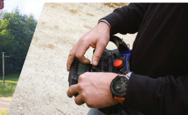
Radio kontrolle vom kran und stabilisatoren
