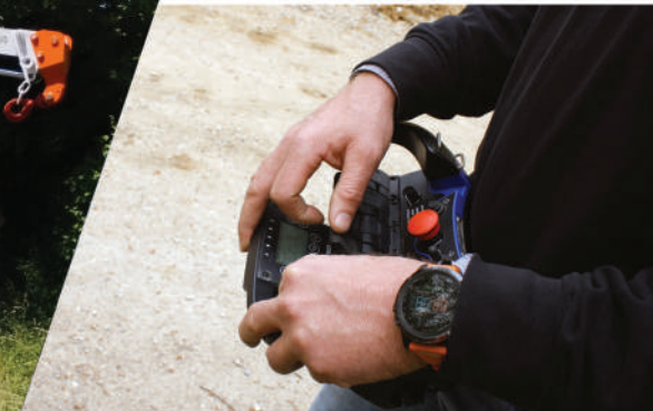
Funksteuerung des Krans und der Abstützungen
