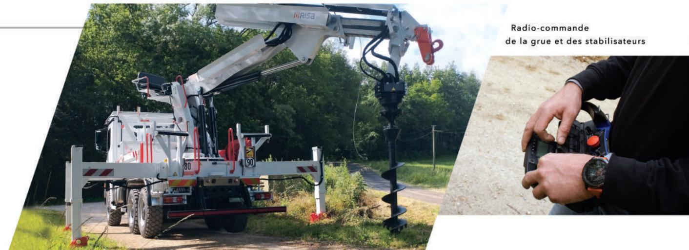
Radio-commande de la grue et des stabilisateurs
