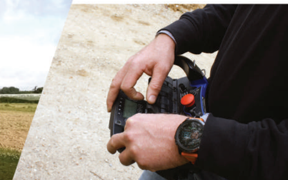
Radio-commande de la grue et des stabilisateurs
