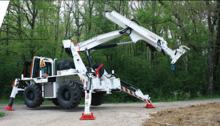
Challenger équipé d'une pince à poteaux hydraulique
