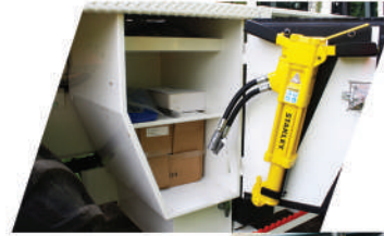
Challenger équipé d'une pince à poteaux hydraulique
