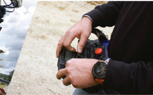
Radio-commande de la grue et des stabilisateurs
