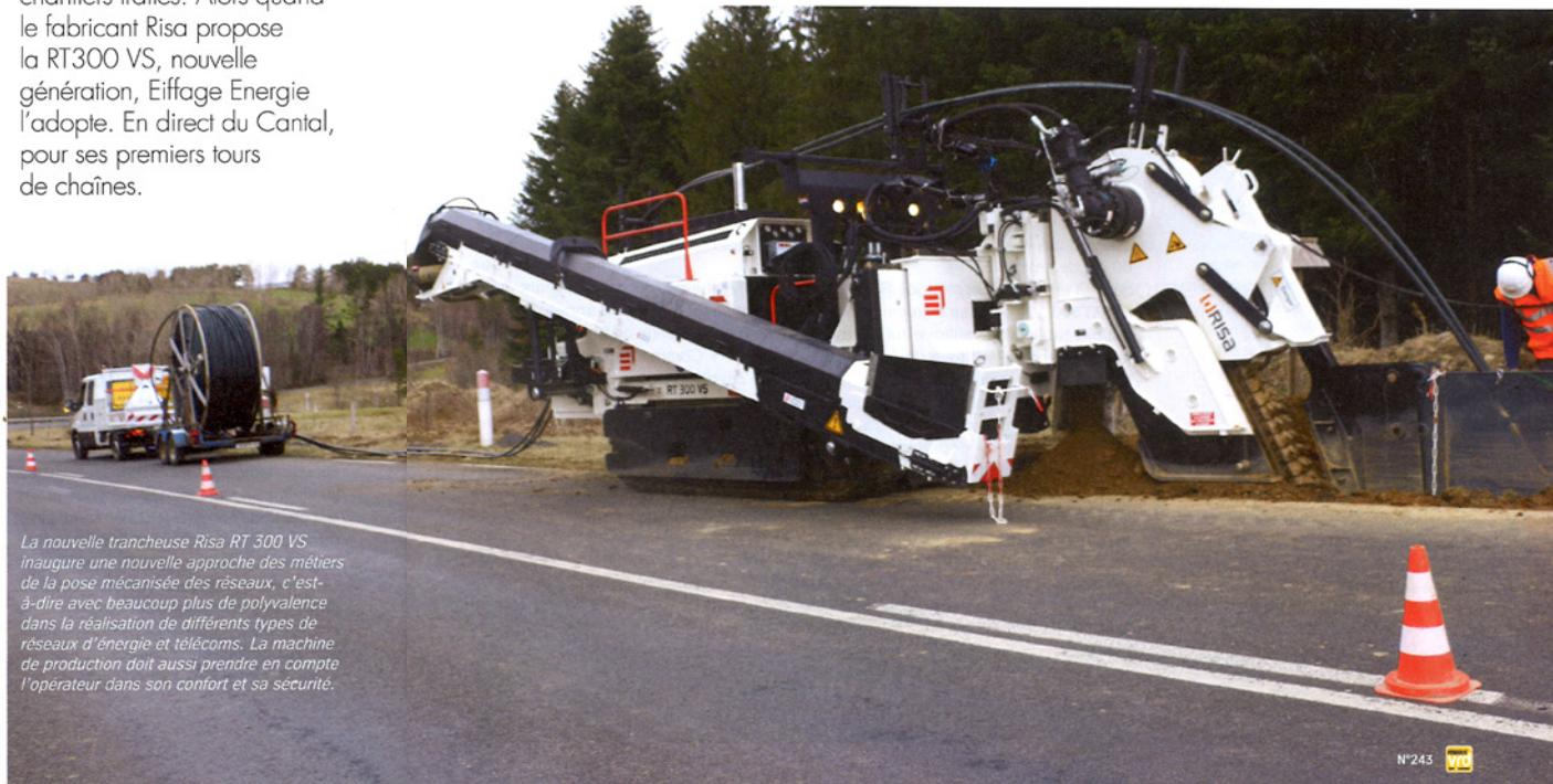
*La nouvelle trancheuse Risa RT 300 VS inaugure une nouvelle approche des métiers de la pose mécanisée des réseaux, c'est-à-dire avec beaucoup plus de polyvalence dans la réalisation de différents types de réseaux d'énergie et télécoms. La machine de production doit aussi prendre en compte l'opérateur dans son confort et sa sécurité.*
